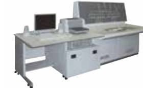
受配電監視制御装置
